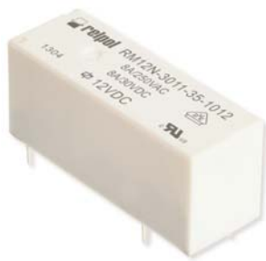
Rys. 5. RM12N – przekaźnik miniaturowy, jeden zestyk przełączny, maksymalne obciążenie 8 A / 250 V AC, 8 A / 30 V DC
