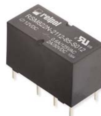
Rys. 3. RSM822N – przekaźnik subminiaturowy, dwa zestyki przelączne, znamionowy maksymalny prąd obciążenia 0,6 A / 125 V AC, maks. 3 A / 30 V DC
